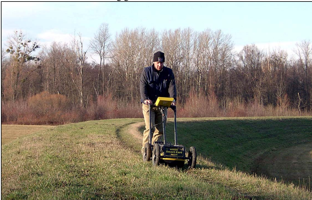
Abb.: 1: Vorerkundung mittels Georadar auf einem Donauhochwasserschutzdamm
